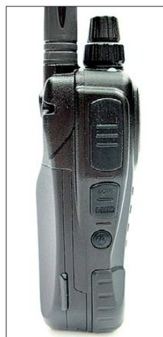
Bild 2: Auf der linken Seite des sehr handlich geformten Geräts befinden sich die große Zweitfunktionstaste, eine weitere zum Öffnen der Rauschsperr- und Einschalten der Beleuchtung und der etwas schwergängige Einschaltknopf, der dadurch versehentliches Einschalten erschwert.
