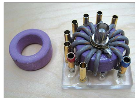
Bild 2: Ansicht des Abwärts-Transformators, links daneben der verwendete Kern
