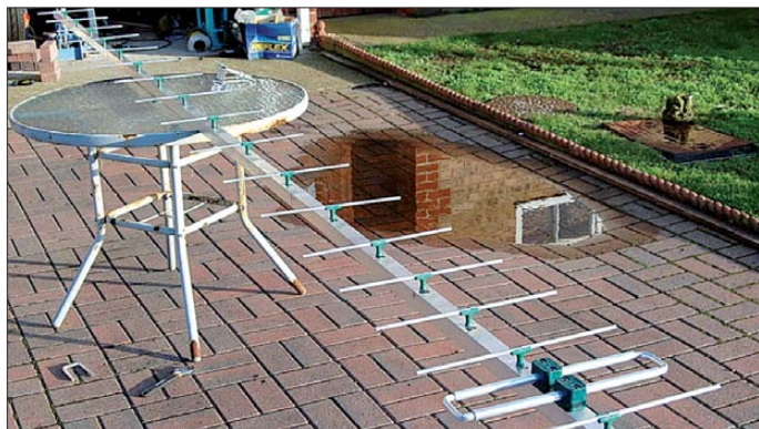
Bild 1: Eine fertig aufgebaute LFA-Yagi, hier für 70 cm, im Experimentalstadium; deutlich ist im Vordergrund der Strahler in Form einer horizontalen Rechteckschleife zu erkennen.
