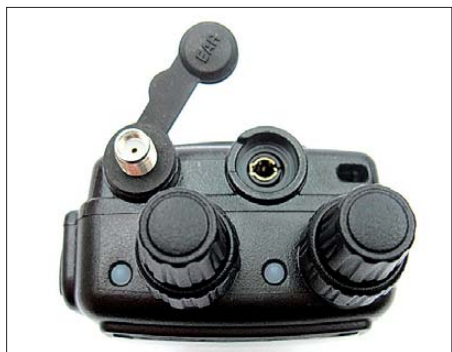
Bild 4: Für jeden der beiden gleichzeitig betreibbaren Empfangsteile gibt es eigene Abstimm- und Lautstärkeinstellknöpfe.
