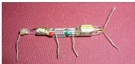
Bild 1: Ein Quecksilber-Stabrelais; die Anschlüsse dürfen nicht zu dicht am Glaskörper umgebogen werden. Foto: DL8ZX
