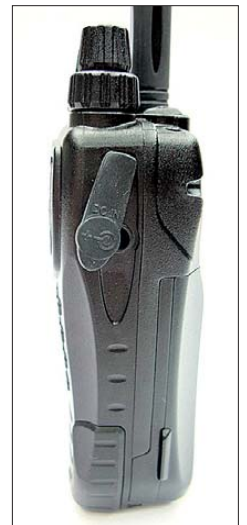
Bild 3: Die Stromversorgungsbuchse auf der rechten Seite dient zum Laden des Akkumulators, sofern nicht der mitgelieferte Standlader oder der Batteriekasten eingesetzt wird.
