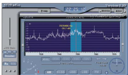
Bild 11: Bei Verwendung anderer Programme wie SDRRadio sind der Offset von 12 kHz sowie die im Programm nicht passende Frequenzanzeige zu beachten.
