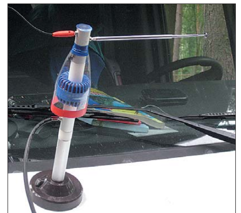
Bild 6: Die auf dem Magnetfuß befestigte 80-m-Spule mit dem Teleskopstab zur Abstimmung Fotos: DJ6HP
