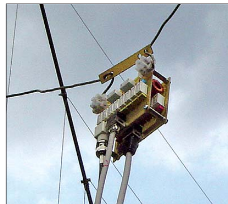
Bild 7: Der Antennenkoppler hängt beim Einsatz frei am Speisepunkt der Antenne. Im Hintergrund sind die Drähte der auf fünf Bänder erweiterten Quad zu sehen.
