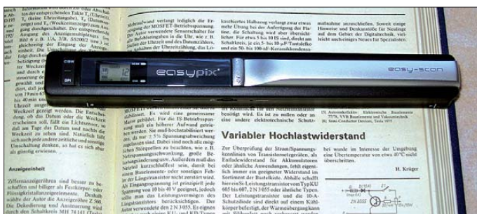
Bild 1: Easy-Scan im Einsatz; beim Darüberziehen tasten die Sensoren das Dokument ab.
