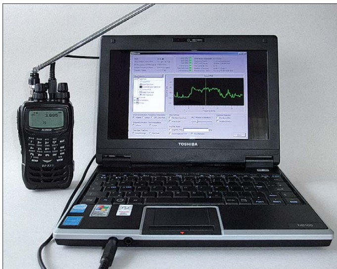
Bild 8: Der Digitalausgang erweitert die Empfangsmöglichkeiten schier ins Unermessliche. Um den für DRM notwendigen 15 dB Signal-Rausch-Abstand zu erreichen, sind allerdings ein paar Meter Draht hilfreicher als eine Teleskop- oder gar die originale Kurzantenne.
