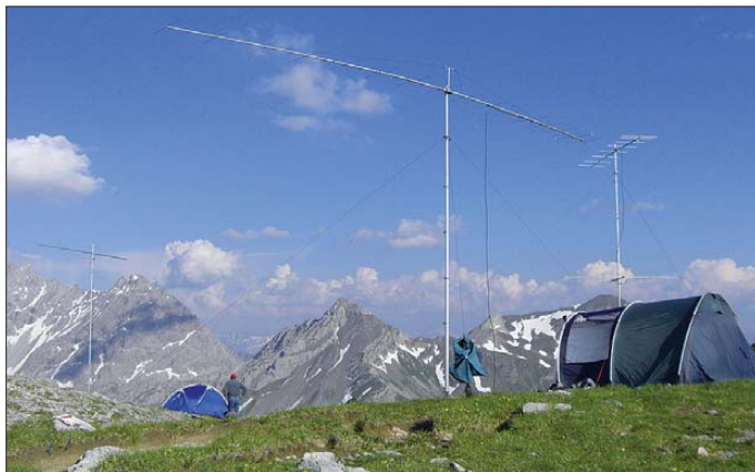
Das 2-m-Stationszelt mit seinen Antennen: im Vordergrund die 17-Element von M 2 mit Rotor, dahinter eine fest ausgerichtete Neuelement-Yagi-Antenne. Im Zelt befanden sich Elecraft K3, DB6NT-Transverter TR-144+40, Beko HLV-1500 und Leistungsteiler für zwei Antennen.
