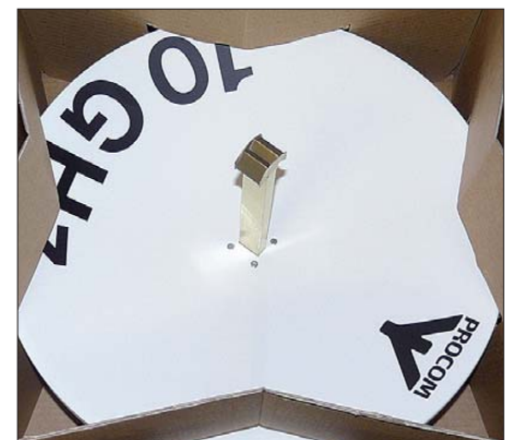
Bild 7: Eine gegenüber Koaxialkabel verlustlosere Signalübertragung gelingt mit einem Hohlleiter bis zum Strahler im Parabolspiegelbrennpunkt.
