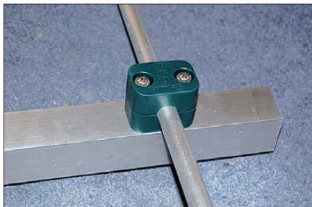
Bild 2: Nahaufnahme der Elementhalterung; sie sorgt für minimale Berührungsflächen.
