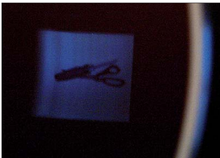
Bild 1: Als Modell für den Nipkow-Fernseher dienen der Motor einer alten Festplatte und eine CD mit einer Lochmaske entsprechend Bild 2. Dadurch lassen sich Bilder in 32 Zeilen darstellen, wie hier ein Schraubendreher und eine Schere. Foto: Sander
