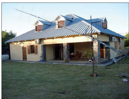
Im Mai war eine Gruppe niederländischer Funkamateure mit einer 2 x Zehnelement-Kreuzyagi-Antenne auf Mauritius auf 2 m per EME QRV. 3B8EME erreichte trotz der QRP-Ausrüstung 340 QSOs – Weltrekord für EME-DXpeditionen. Foto: PE1L
