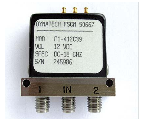
Bild 6: Koaxiales Umschaltrelais mit SMA-Buchsen für Frequenzen bis 18 GHz. Etwas preiswertere Ausführungen vom Gebrauchtmärkte benötigen meist die höhere Schaltspannung 28 V!
