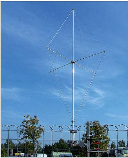
Bild 4: Musterantenne in Messposition; der Strahler ist eine 2,5 m hohe endgespeiste Reuse mit 1,34 m Bauchdiagonale.
